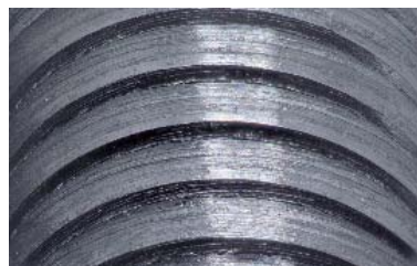
Dopo la maschiatura di 184 fori con VUSP CH la finitura della superficie è ancora eccellente.
